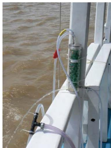
**Figure 1.** A : Carte de la zone d'étude sur la rive gauche de l'estuaire de l'Amazonie (source : IEPA). B : Photo de l'équilibrateur permettant d'acquérir la pCO<sub>2</sub> dans l'eau en continu.
